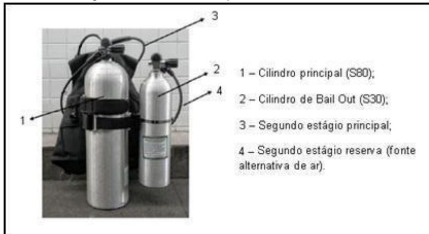
Figura 2 - Cilindro Principal com Redundância
