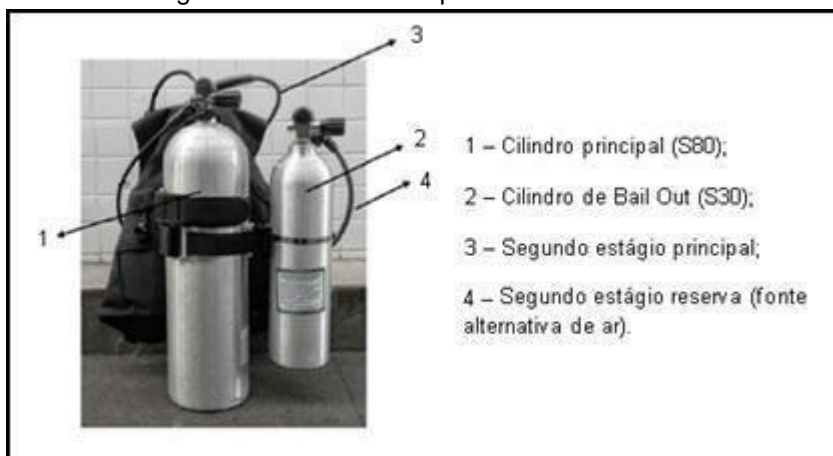
Figura 2 - Cilindro Principal com Redundância
