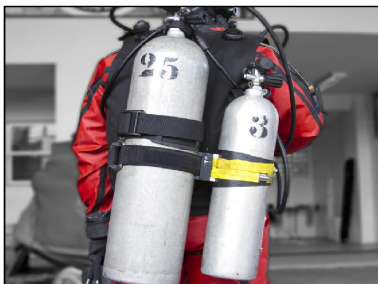
Figura 3 - Cilindro bail out (S30) afixado ao Cilindro principal (S80)
