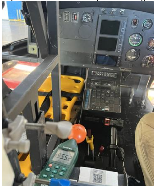
Figura 2 – Posição do medidor de campo eletromagnético na cabine
